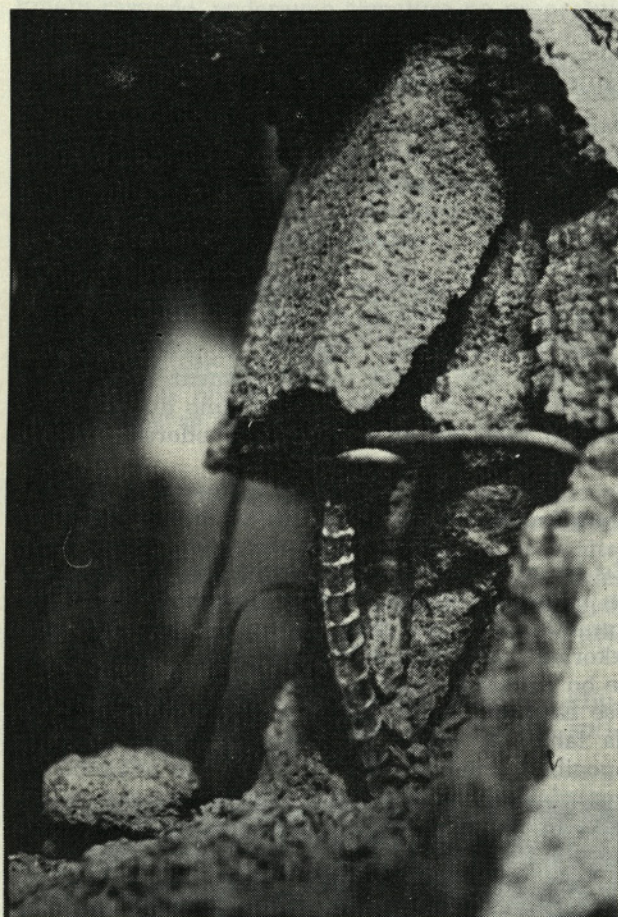
Slika 10. Uklon tlačne armature in drobljenje zidakov in zalivne mase pri upogibni porušitvi armiranega zidu
