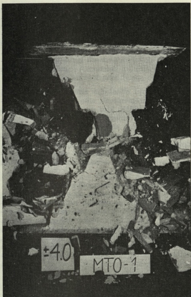
Slika 1. Nearmirani zid v trenutku strižne porušitve
