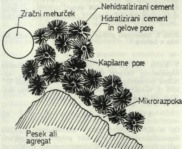
Slika 2. Shematski prikaz mikrostrukture betona
