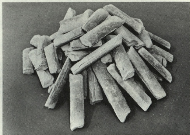
Slika 14. Briketi titanove sadre, proizvedeni v firmi Knauf, Iphofen
