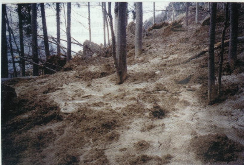
Slika 3: Blatni tok nad Mangartsko planino. Danes na srečo že poznamo lastnosti toka, ki je kot primer prikazan na sliki. Vlažnost: 14 – 24 %; volumenska koncentracija: 0,58 – 0,72; viskoznost: 30 – 104 Pas.
