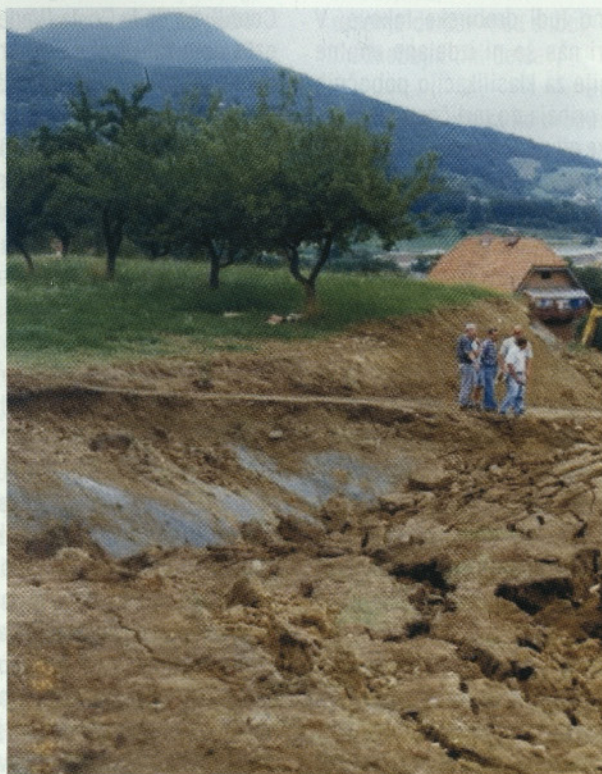
Slika 1: Translacijski zdrs zemljine po predkvartarni hribinski podlagi iz oligocenske sivice. Zelo pogost, za geotehnične raziskave in analizo »zelo hvaležen« plaz.
