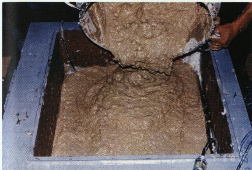
Slika 16: Polnjenje strižne celice z gruščem pri vlažnosti okrog 15 %. Bi po videzu materiala lahko sklepali, da je židka masa v resnici debelozrnat grušč? (Fotografija iz arhiva ZAG).
