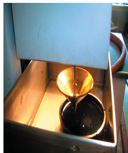
Slika 4 • Penetracijo smo izvajali s konusom
