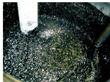
Slika 2 • Vzorec gumibitumna RmB z 18 ut. % gumenega prahu
