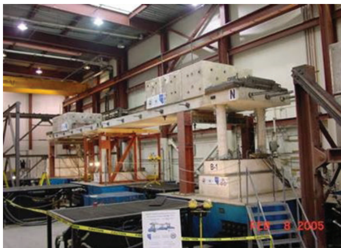
Slika 9. Test potresnega odziva viadukta na treh potresnih mizah na UNR, ki smo ga analizirali na IKPIR.
