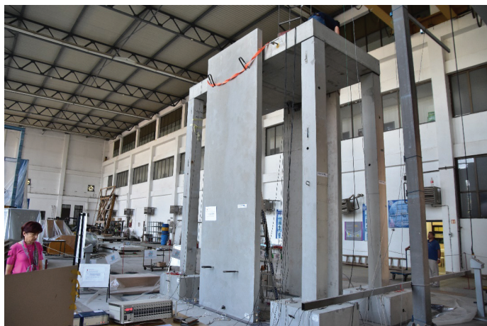
Slika 8. Testi fasadnih panelov v naravnem merilu, izvedeni na potresni mizi IZIS v Skopju.
